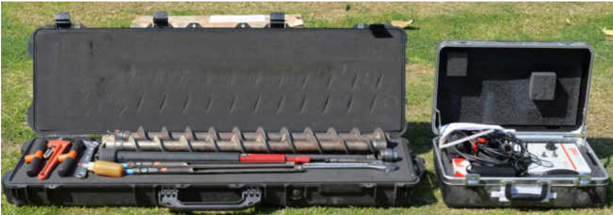
(d) Hollow Stem Auger Kit with Peristaltic Pump
